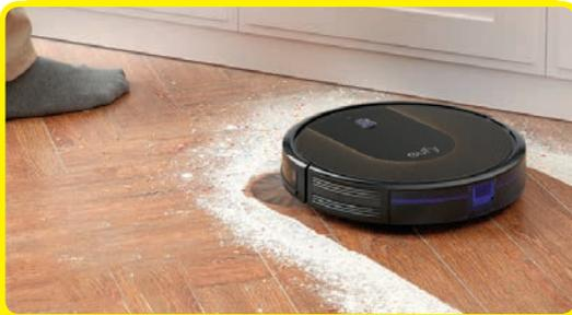
▲ Der Robovac scannt den Raum, der zu reinigen ist, nicht. Im Lieferumfang sind Magnetstreifen enthalten, die den Sauger vor gefährlichen Abgründen (die Stiege!) warnen. Sind die nicht montiert, geht es mitunter unfreiwillig bergab.
