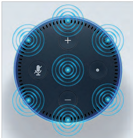
▲ Der Echo Dot verfügt über sieben Mikrofone und sogenannte „Richtstrahltechnologie“ und soll dadurch in der Lage sein, die für ihn entscheidenden Ansagen herauszufiltern und zu verstehen.
