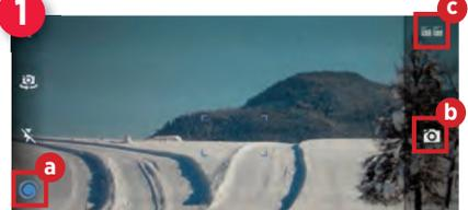
Bei dieser Funktion werden mehrere Fotos schnell hintereinander erstellt, was einen kurzen Film ergibt. Lösen Sie aus, indem Sie auf das Kamera-Symbol auf der rechten Seite tippen **1b**. Der Live-Shot wird gespeichert. Sie können ihn begutachten, indem Sie rechts oben auf das Symbol tippen **1c**. Sie gelangen in den Medienmanager und wählen den soeben aufgenommenen Live Shot per Fingertipp aus. Tippen Sie auf das Foto und halten sie den Finger gedrückt, wird der Kurzfilm abgespielt.
