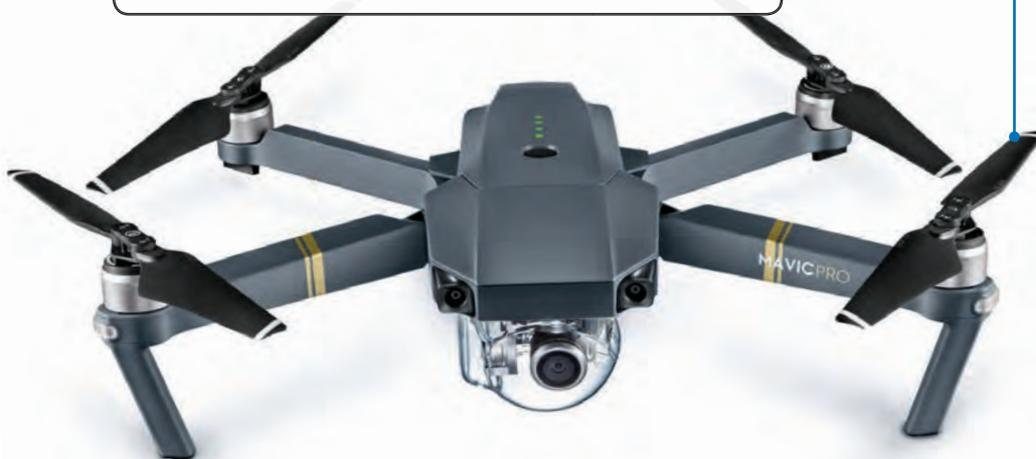
Ausgeklappt nimmt diese Drohne eine Fläche von 23,4 x 27 cm ein, zusammengeklappt ist sie so klein wie eine Trinkflasche.
