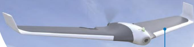
Die Tragfläche sorgt für Auftrieb, es braucht dazu also keine kleinen Vertikalrotoren. Schweben kann die Flügel Drohne aber nicht.
