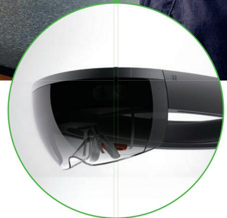
Hinter den getönten Gläsern sitzen semi-transparente Bildschirme, eine Kamera und Lagesensoren, mit denen HoloLens die Position des Kopfes verfolgt.
